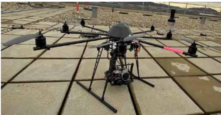
**Abb. 1: Oktokopter mit IR- und Tageslichtkamera der HS-Coburg**
